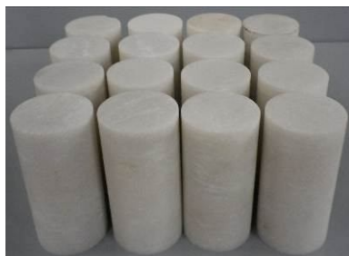
图6 制备完成的大理岩试样
